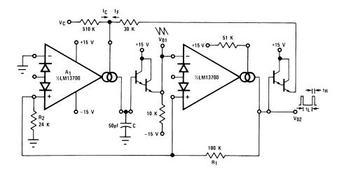
$$\begin{split} V_{PK} &= \frac{(V^+ \pm 0.8 V) \, R_2}{R_1 + R_2} \\ t_H &\approx \frac{2 V_{PK} C}{I_F} \\ t_L &= \frac{2 V_{PK} C}{I_C} \\ f_0 &\approx \frac{I_C}{2 V_{PK} C} \, \text{for} \, I_C <<$$
