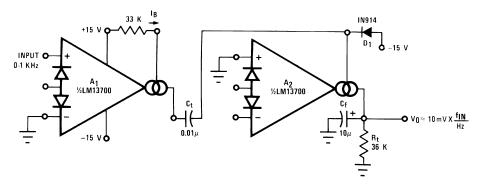
Figure 29. Tachometer
